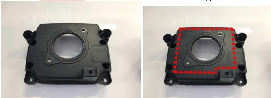
Le conduit d'entrée de la boîte à air (pièce #10) peut être supprimé, les 2 trompettes d'admission peuvent être réduites en longueur autant que souhaité (pièce #12 et #13).
