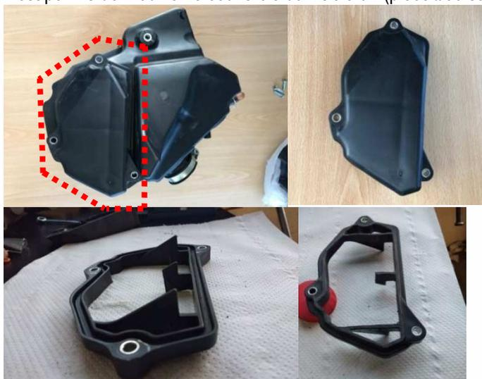
Le conduit d'entrée de la boîte à air peut être supprimé (pièce #28), les 2 trompettes d'admissions peuvent être réduites en longueur autant que souhaité (pièces #26 et #27).
