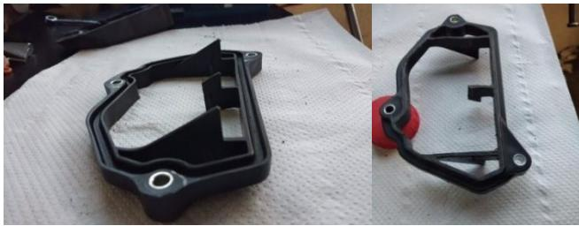
Le conduit d'entrée de la boîte à air peut être supprimé (pièce #28), les 2 trompettes d'admissions peuvent être réduites en longueur autant que souhaité (pièces #26 et #27).
